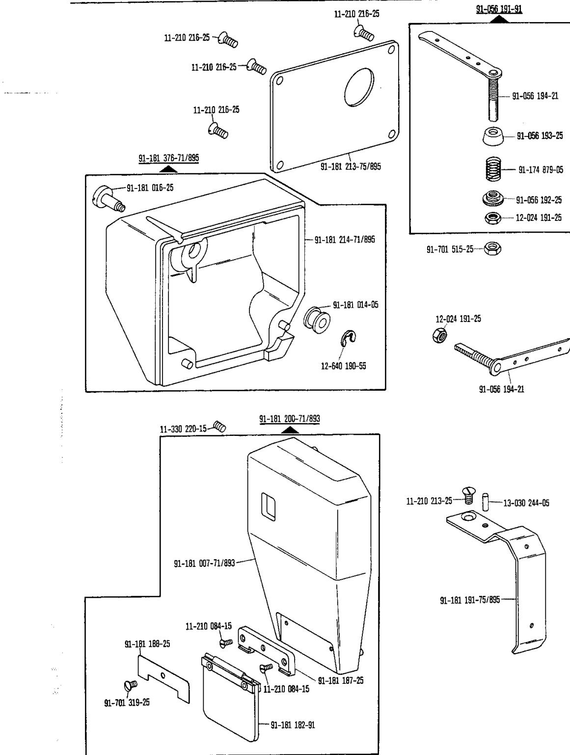
**Gehäuse- und Sockelteile**
